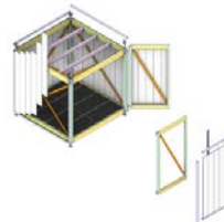
Montage der Wand- und Klappläden
